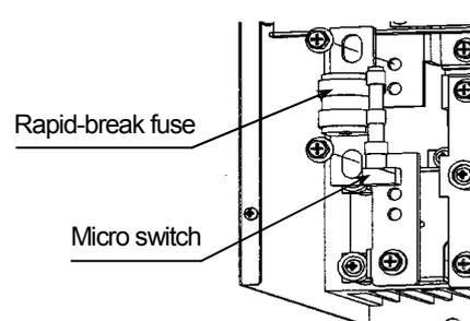
Tightening torque: 5N·m
