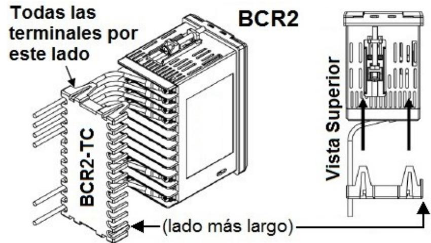
**Conexión de los transformadores de corriente:**
