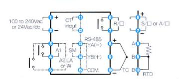
· R/☐ : Relay contact output · S/☐ : Non contact DC voltage output
